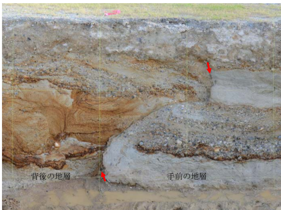
写真 5-4 測点 39-40m 付近の地質境界 (赤矢印が地質境界)
