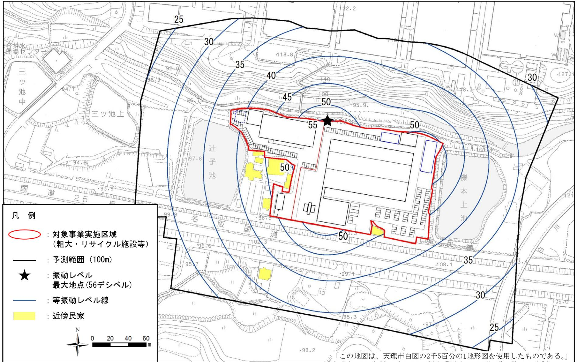
図 7.1-13 建設機械の稼働に伴う振動の予測結果 (粗大・リサイクル施設等)
