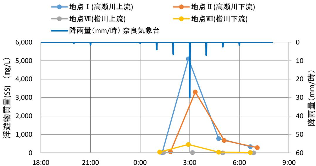
図 7.6-3 降雨量と浮遊物質（SS）の時間変動（平成30年7月28日～29日）
