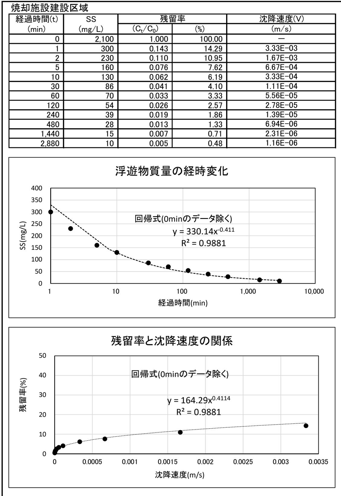
図 7.6-4 土壌沈降試験結果（地点a：焼却施設建設区域）
