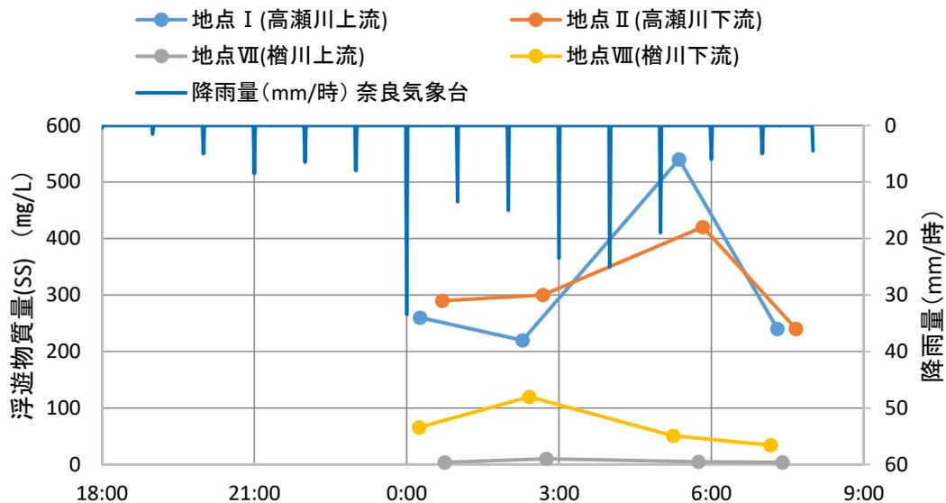
図 7.6-2 降雨量と浮遊物質量（SS）の時間変動（平成30年7月5日～6日）
